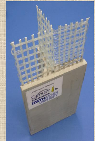
T-elágazású textilbeton szerkezet
