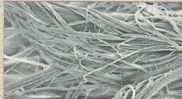
A végeredmény: szétbontott, kb. 500 nm vastagságú elemiszálak
