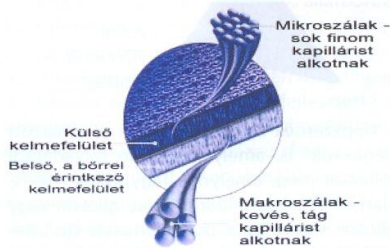
13. ábra. A Polartec Power Dry kelme vázlata
