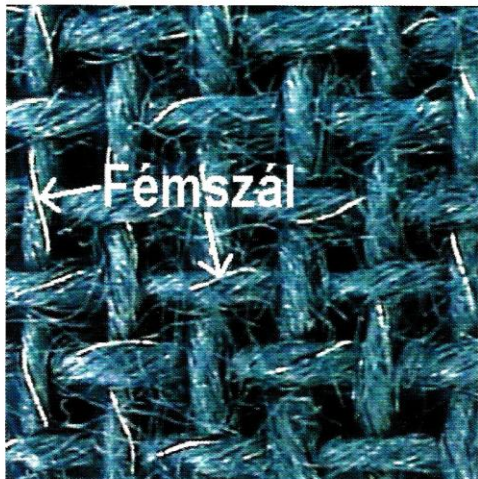
1. ábra - Vezetőképes szál a szövetszerkezetben (Elektrisola Feindraht)
